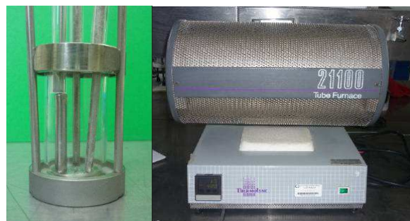
Figura 3. Celda Electroquímica y Horno para Ensayos de Corrosión por Sales Fundidas.
