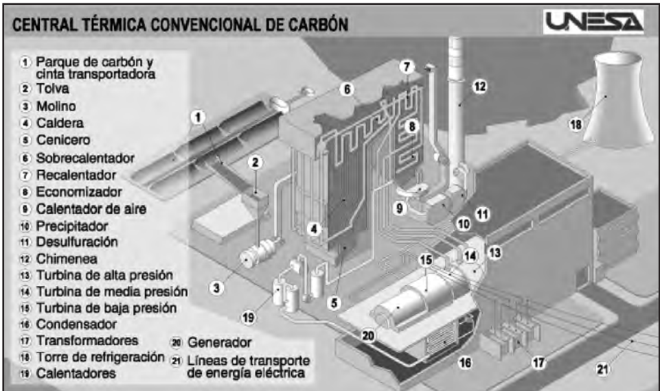
Figura 7.- Esquema de una central convencional de carbón. UNESA.
