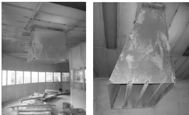
Figura 11. Túnel de curado de piezas y enfocador instalado
