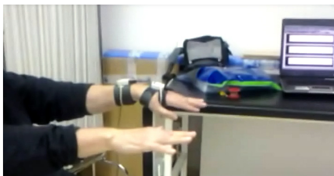
Figura 5. Prueba de registro del temblor con IMUs para validar ortesis.
