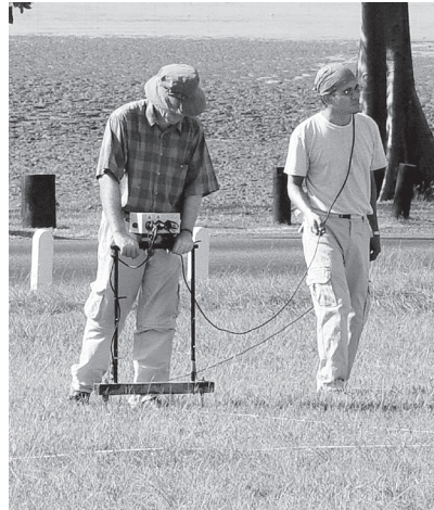
Figura 2. Mapeo geoelectrico en el hospital San Juan de Dios.
