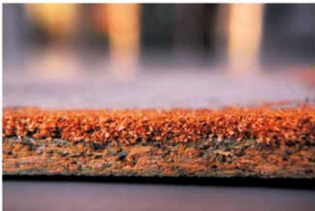
Figura 1. Imagen transversal de una capa de polvillo de aserrín depositada sobre un tablero de astillas convencional.
