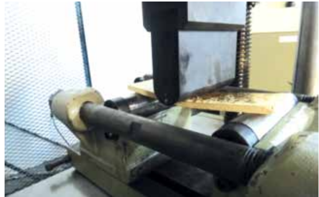
Figura 3. Prueba de flexión estática para tableros aglomerados.
