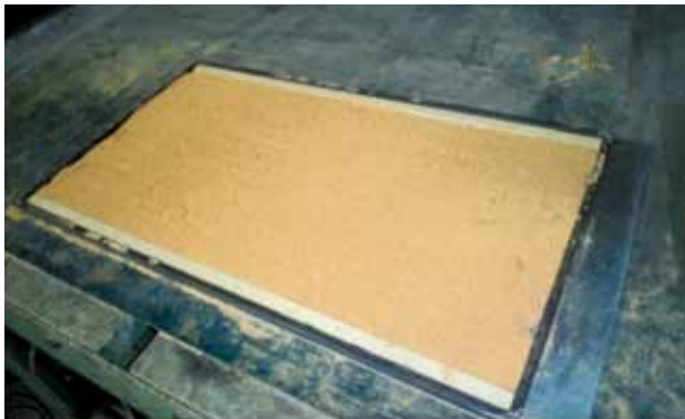
Figura 2. Capa externa de aserrín previa al prensado en caliente.
