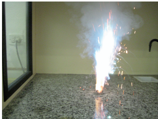
Figura 3. Humos y llamas en la reacción de las sales de amonio con zinc con unas gotas de agua.
