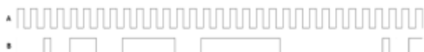
Figura 7. A. señal de reloj B. secuencia pseudo-aleatoria con bit de sincronismo ( t = 1/4 ).
