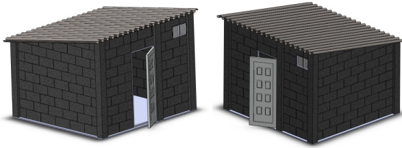
Figura 15. Ensamble de módulo de vivienda ladrillos de plástico
