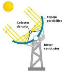
Figura 1. Reflexión de radiación solar sobre punto focal.[8]
