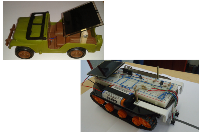
Figura 9. Vehículo solar a escala y oruga seguidor de línea.. Diseñado con transmisión de potencia eficiente. Sube pendientes de 10^\circ con radiación directa pico.
