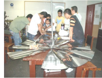
Figura 3. Corte y ensamble cocina parabólica
