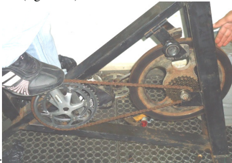
Figura 12. Mecanismo de rotación para generación.
