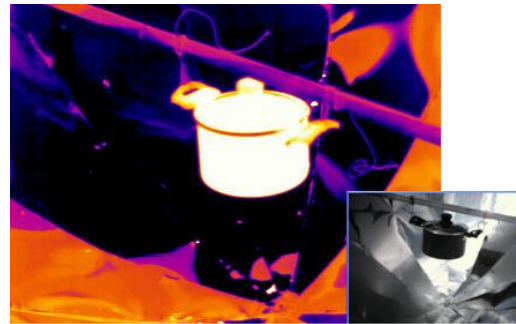
Figura 4. Imágenes termográficas de la cocina solar
