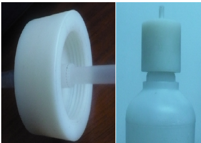
Figura 1. Válvula de carga del valorante. Fuente. Realizada por los autores.
