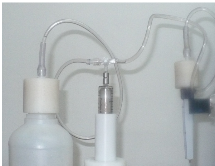
Figura 3. Mangueras y válvula de tres vías. Fuente. Realizada por los autores.
