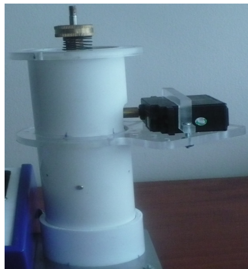
Figura 10. Carcas Inferior con servomotor en soporte. Fuente. Realizada por los autores.
