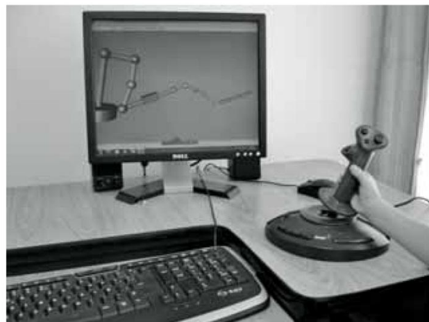
Fig. 8. Usuario manejando el robot a partir del joystick.
