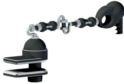
Fig. 3. Interfaz Háptica GIRU diseñada usando SolidEdge®.
