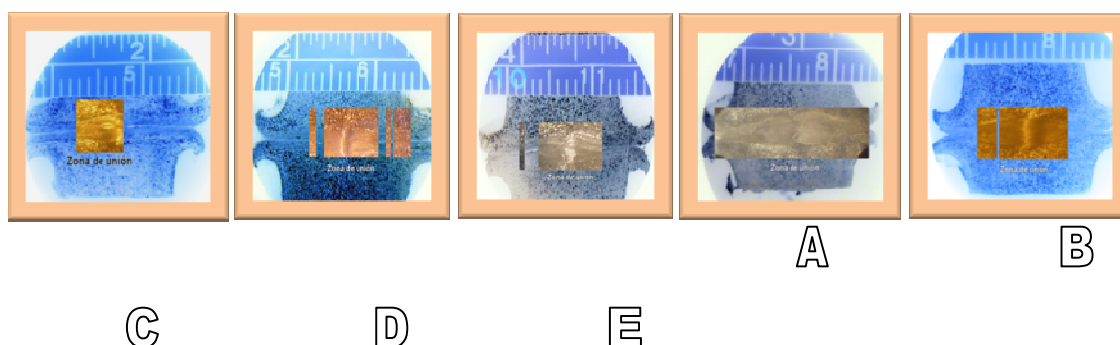
FIGURA. 6. Macrografía tomada en la unión por FRW de un Aluminio AA 6063 a diferentes tiempos de calentamiento. A) 100s. B) 120s. C) 140s D) 160s E) 180s.
