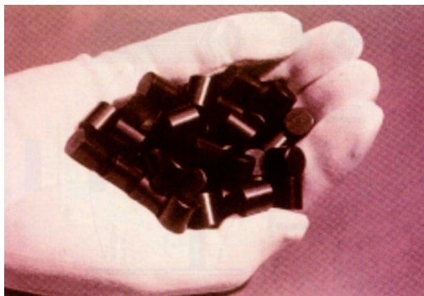
Figura 2. Pastillas sinterizadas de dióxido de uranio enriquecido (cortesía de ENRESA).
