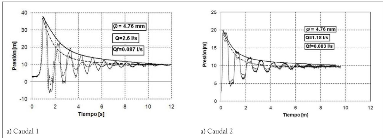
**Figura 3.** Comparación experimental de ondas de presión para un sistema con y sin fugas para diferentes caudales
