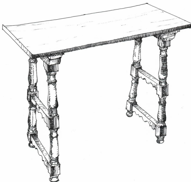
Fig.3 Dibujo de Jorge Arruga Sahún de un pie de escritorio tipo del siglo XVII con cuatro patas inclinadas con balaustres en las que se ensamblan dos travesaños en cada lado.
