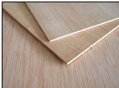
Fig. 5. Imagen de las tablas contrachapadas de okume de 4 milímetros de espesor. Fotografía: Javier Albar
