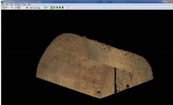
Fig. 33: Vista 3D del modelo con textura de la cámara interna sin aplicar aún las ortofotos obtenidas con la cámara externa.
