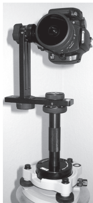
Lám. 3: Vista del NNB y cámara digital sobre el trípode del TLS.
