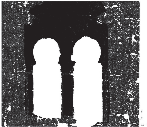
Fig. 22: Mallado de la ventana de doble arco a la resolución de 0,5cm.
