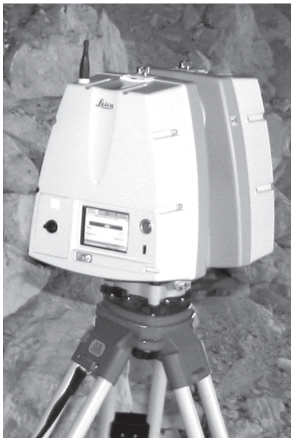
Lám. 2: Imagen del láser escáner 3D utilizado para el HDS.
