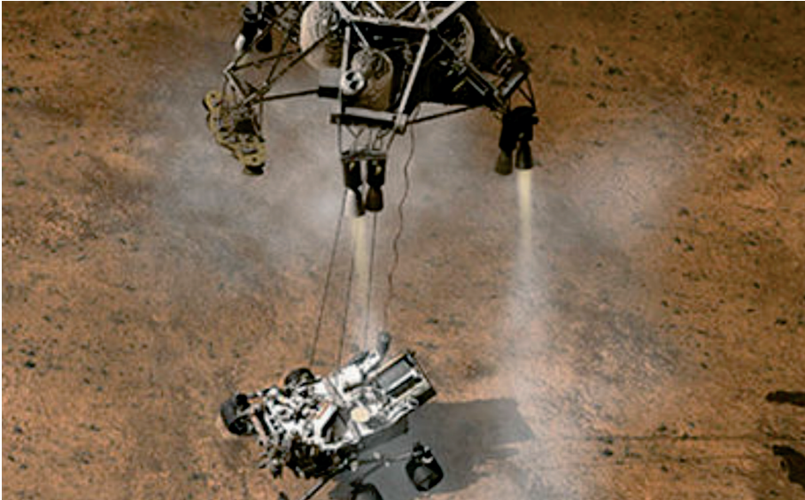
Foto 1. El laboratorio espacial de la NASA lleva al vehículo Curiosity Rover, de una tonelada de peso, en su cita con Marte. Foto difundida por la NASA en su página web: http://ciencia.nasa.gov/ciencias-especiales/30jul_skycrane
