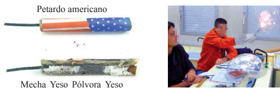
Figura 5. Sección interna de petardo (izqda.) y experiencia con petardo abierto en laboratorio (dcha.).
