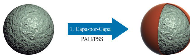
Figura 1. Formación de la membrana polimérica constituida por polielectrolitos (PAH/PAS) alrededor de la partícula de poliestireno empleada como soporte.
