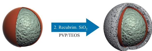
Figura 4. Recubrimiento con sílice del nanocompuesto PS@PE mediante el uso de PVP como agente acoplante y TEOS.
