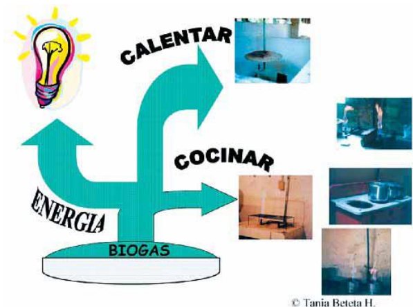
Figura 1. Algunos usos del biogás en la unidad de producción: energía eléctrica; calentadores; fogones y diferentes cocinas adaptadas.
