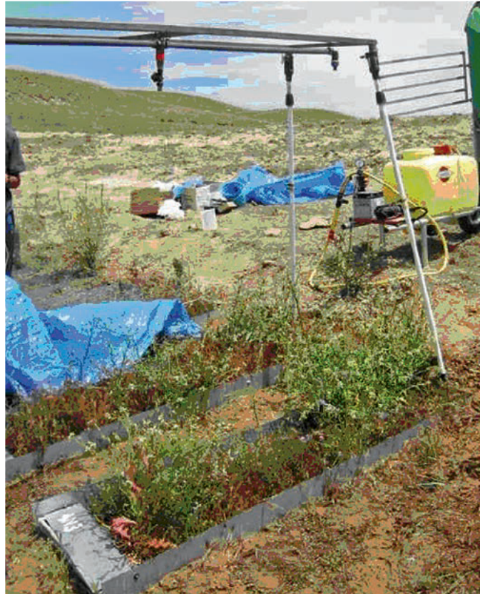
Figura 2. Simulador de lluvia sobre parcela de 1 m 2 antes de colocar los cortavientos.
