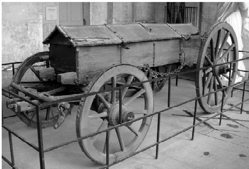
Ilustración 48.- Carro de municiones. Furgón de tren de artillería del sistema Gribeauval. Museo del Ejército de París.
