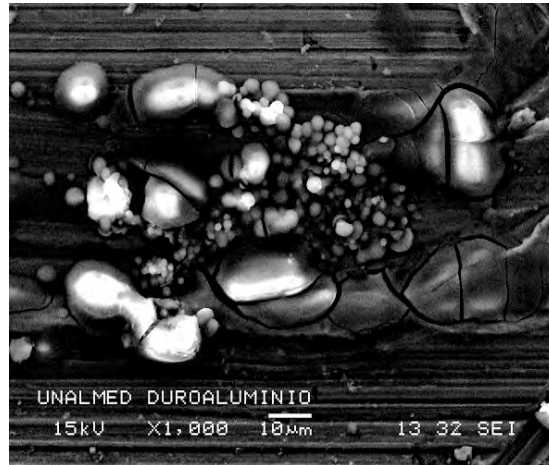
Figura 5. Morfología tomada mediante SEM del duraluminio a veintiocho días en E-100 donde se observaron los productos de corrosión
