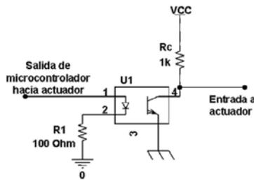
Fig. 7. Etapa de potencia para una actuador.
