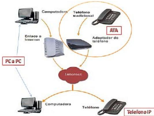
Fig. 1. Tipos de transmisiones VoIP [3].
