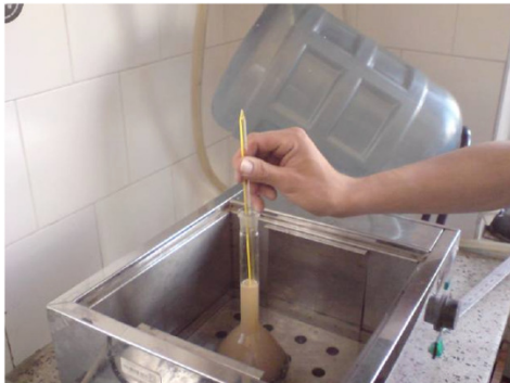
Fig. 9. Uso del picnómetro para estimación de pesos específicos.
