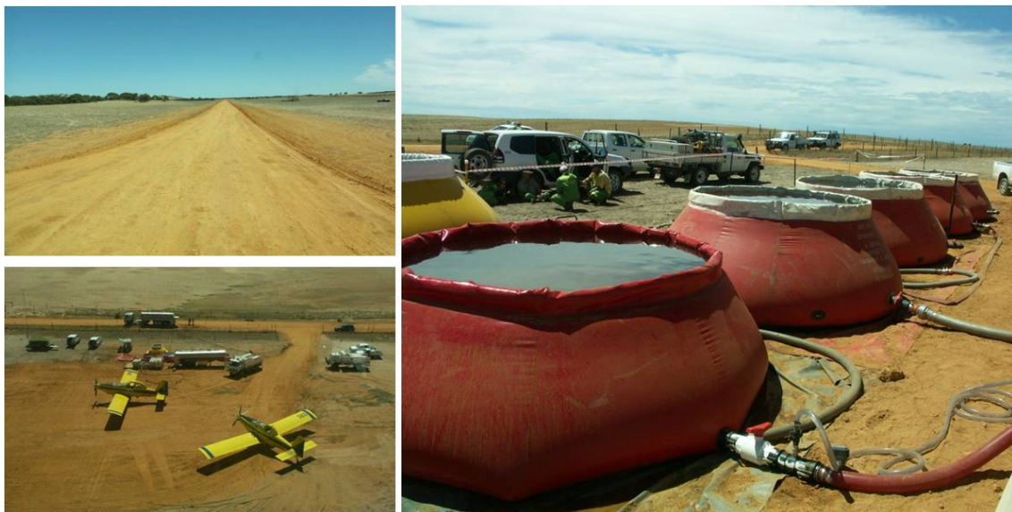
Figura 5 . Infraestructura para la realización de las descargas de productos químicos (retardante a largo plazo, gel y espuma).
