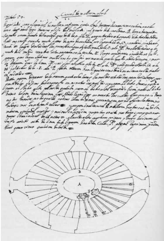
Figg. 4-5. "Caracol de emperadores" y traza del "caracol de Mallorca oval" según Alonso de Vandelvira (da A. de Vandelvira, Libro de trazas de cortes de piedra..., ms., XVI sec.).
