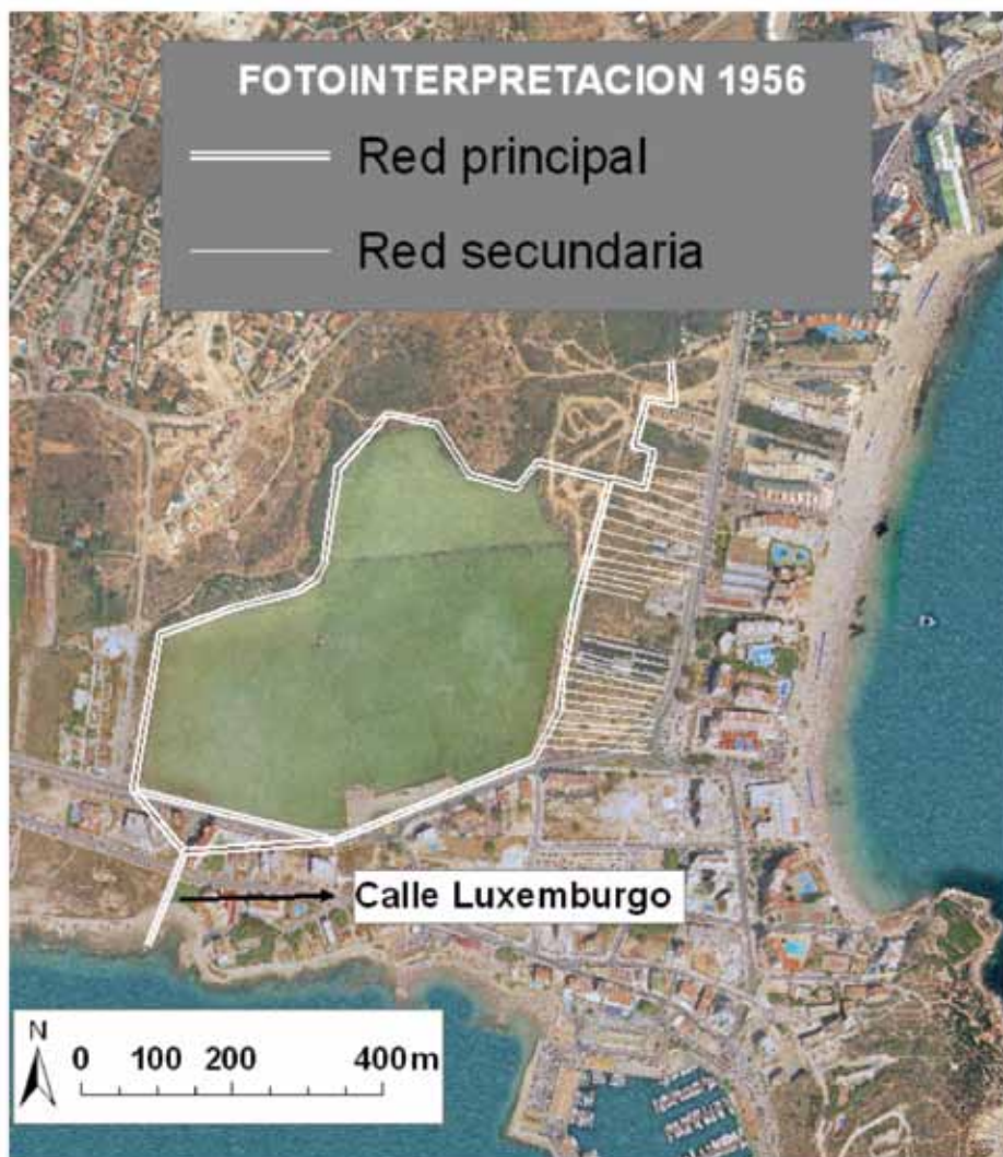
Figura 8. Desestructuración del sistema de drenaje artificial (red drenaje de la salina y su entorno)
