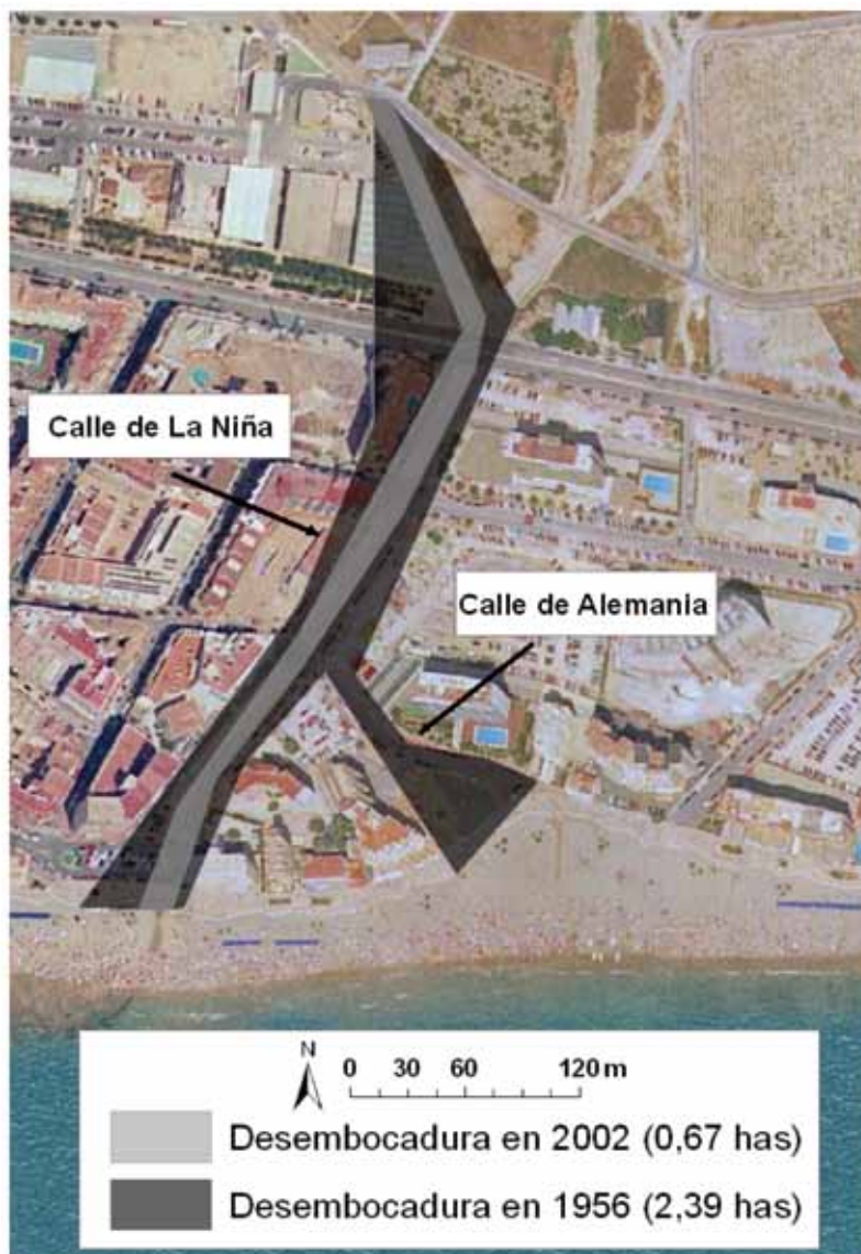
Figura 7. Desestructuración del sistema de drenaje natural (constreñimiento del barranco Quisi-Pou Roig).
