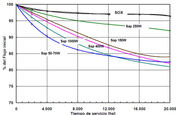
**Fig. 1. Depreciación del flujo luminoso para lámparas de Sodio a partir de 100 h cuando se ha estabilizado. Gentileza de Philips Lighting Argentina [5]**
