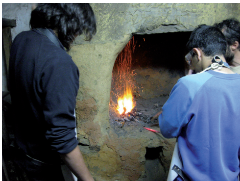
Figuras 5 y 6. Comprobación de propiedades mecánicas del hierro en una fragua tradicional.
