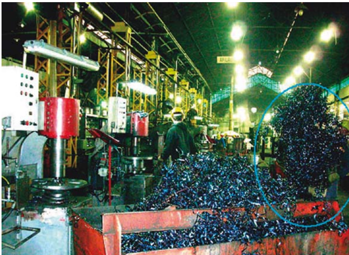
Figura 7. Viruta de acero de la operación de afilado
