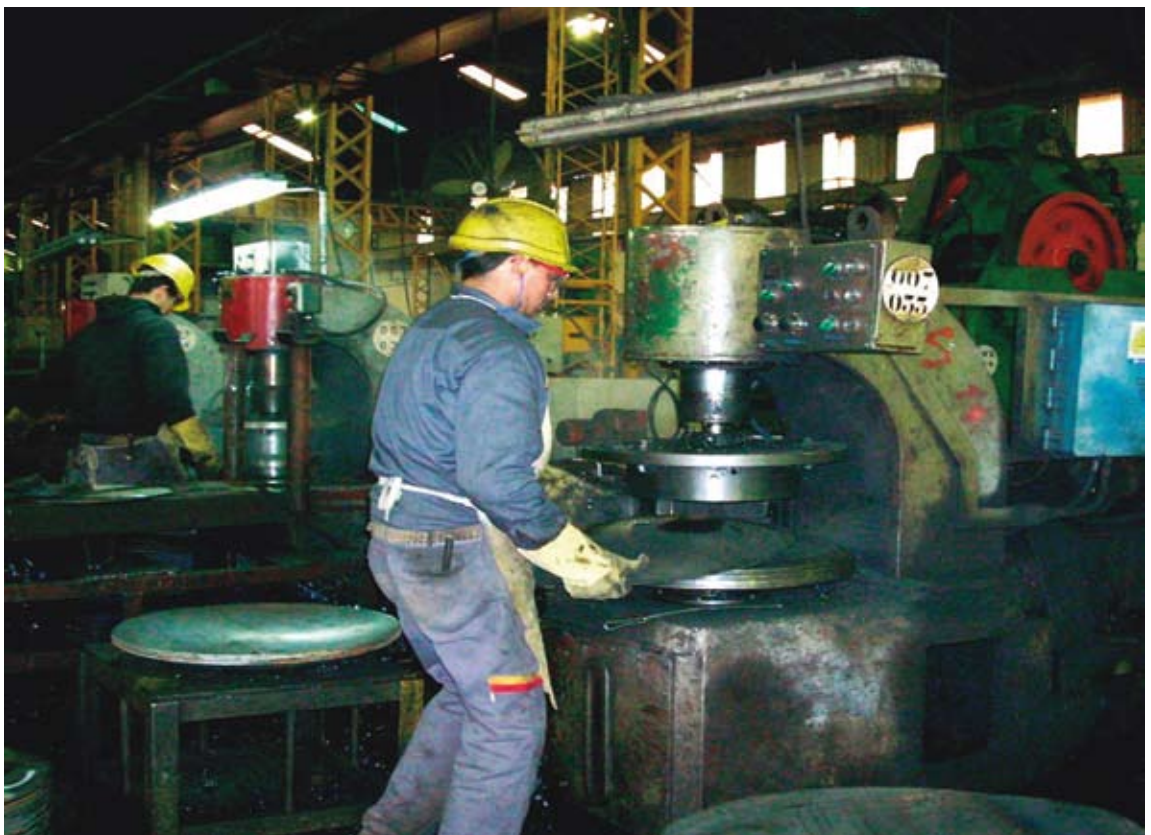
Figura 6. Carga y descarga de discos en el torno
