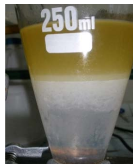
Figura 8. Biodiesel puro en la fase superior y agua clara en el fondo
