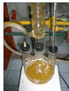
Figura 2. Montaje del matraz de tres cuellos para realizar la reacción de transesterificación.
