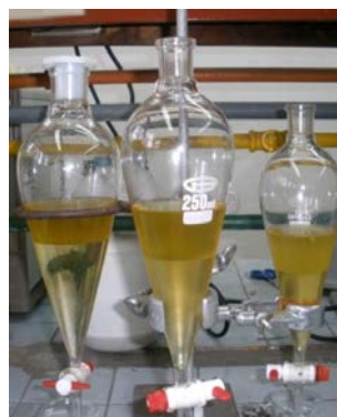
Figura 7. Separación del Biodiesel y la glicerina
