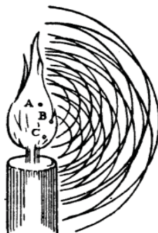
Fig. 1: Desenho retirado do Tratado: ondas concêntricas a partir dos pontos A, B e C de uma vela.
