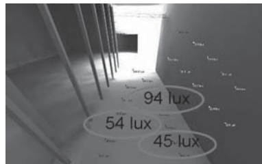
Figura 26. Iluminación simulada en ECOTECT (sin espejos parabólicos)
