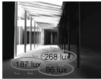
Figura 24. Mapa del Factor de luz natural del hall (con espejos parabólicos simples)
