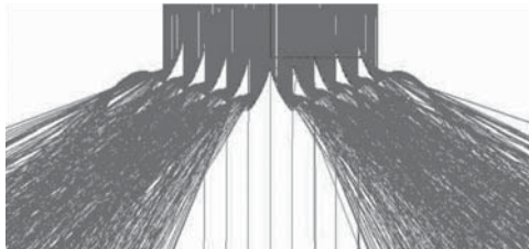
Figura 16. Diagrama de trayectoria de los rayos solares sobre espejos parabólicos simples a lo largo del hall.
