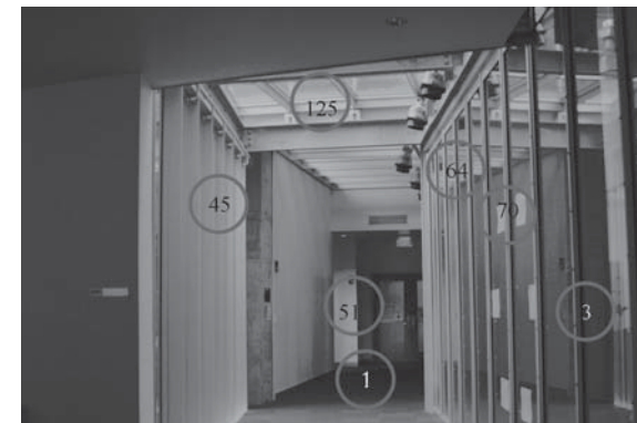
Figura 10. Imagen del Alto Rango Dinámico del hall, con puntos de luminancia.
