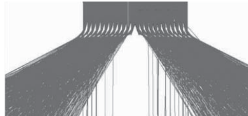
Figura 18. Diagrama de trayectoria de los rayos solares sobre espejos parabólicos dobles a lo largo del hall.
