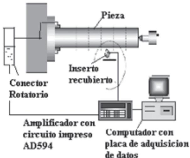
**Figura 2.** Esquema de la instalación experimental para la medición de la temperatura en la zona de corte (escala 1:50).
