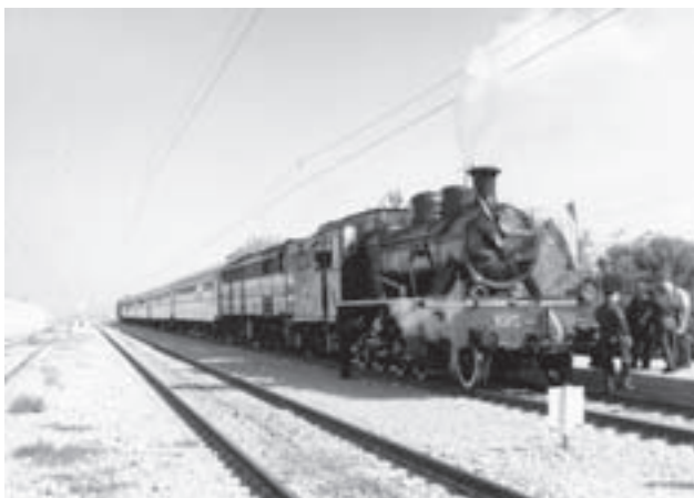
5.- Locomotora 140-2054 RENFE, ex 4106 de Andaluces. Construidas por Babcock & Willcox basándose en el diseño, primero de las 140 introducidas por North British y posteriormente por Baldwin, constituyeron un conjunto de locomotoras que serían, en la época del vapor, las indiscutibles reinas de la línea. Locomotoras de diseño muy sencillo y limpio, resultarían muy versátiles para todo propósito gracias a su diámetro de ruedas motoras: 1310 ó 1410 mm según serie. Tan sólo esta, la 2054, ha sobrevivido hasta nuestros días gracias a su colaboración en diversos westerns filmados en el desierto almeriense, utilizando el antiguo ramal de Minas de Alquife. En la imagen la vemos en doble tracción con la diésel 1604 en una circulación especial Sevilla-Jerez de la Frontera en octubre de 1981. Actualmente se encuentra en estado de marcha y debidamente preservada en Guadix. Foto autor.
