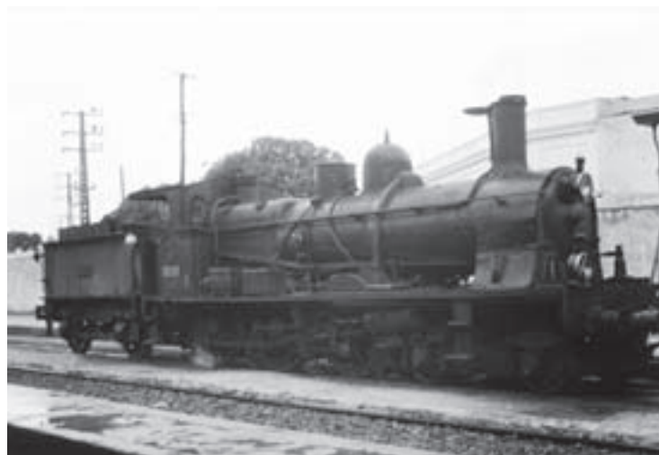
4.- Locomotora 230 Compound De Glenn serie 301 a 333 de Andaluces. Fabricadas por Euskalduna a partir de un anticuado modelo de Societé Alsacienne (301 a 310), de 1903, eran excelentes corredoras, lo que imposibilitaba su adaptación a nuestra línea con sus duros perfiles. Máquinas de diseño muy armonioso y bello diseño, que evidenciaba de forma clara su origen francés. Curiosamente, las diez primeras fueron suministradas por Graffenstanden bajo licencia de Societe Alsacienne; de la 311 a la 333 por Babcock & Willcox y Eskalduna. Foto colección autor.
