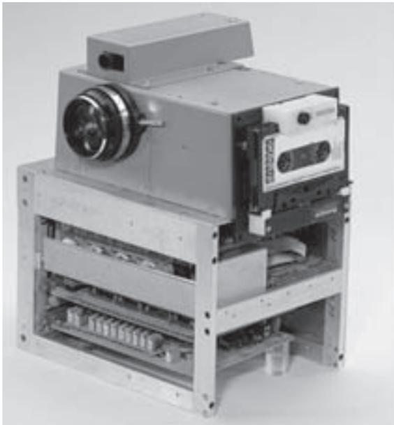
Figura 8.- Prototipo pionero de cámara fotográfica digital con CCD, fabricado por Steve Sasson en 1975
