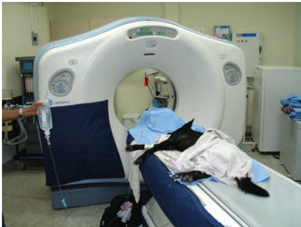
Figura 3. Tomógrafo del Hospital San Vicente de Paúl (Medellín, Colombia). En la imagen se observa el Gantry y la mesa del paciente, donde se realiza la recolección de datos.
