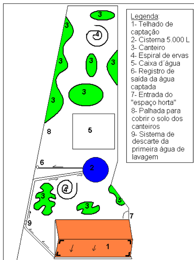
Figura 7- Croqui do “espaço horta” com a captação de água da chuva
