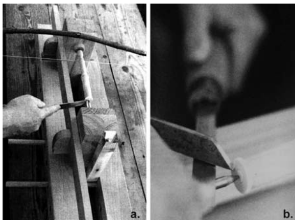
Lámina 3. a) Restitución experimental de un torno de arco para la elaboración de piezas de hueso (Picod, 2004, p. 71, fig. 3); b) detalle de la realización de las molduras circulares concéntricas durante el proceso de experimentación arqueológica (Picod, 2004, p. 72, fig. 4).
