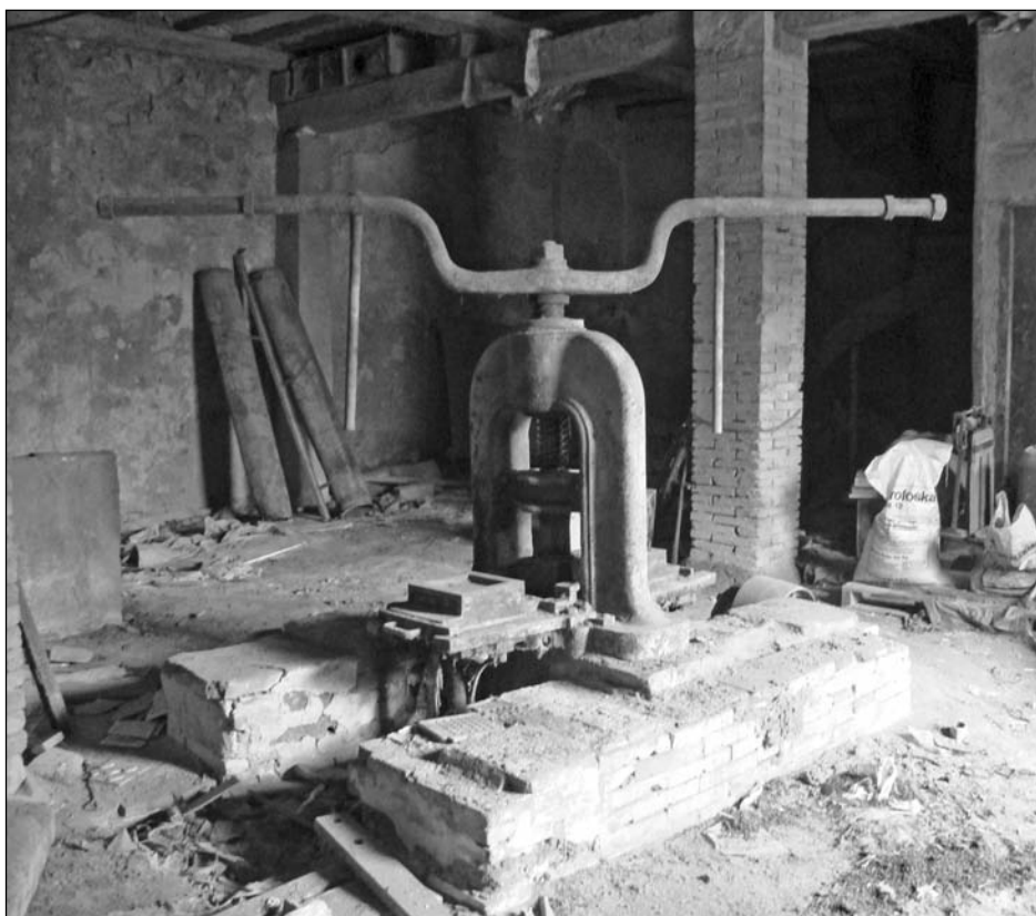
Prensa de timbre o tornillo (Fotografía del autor)
