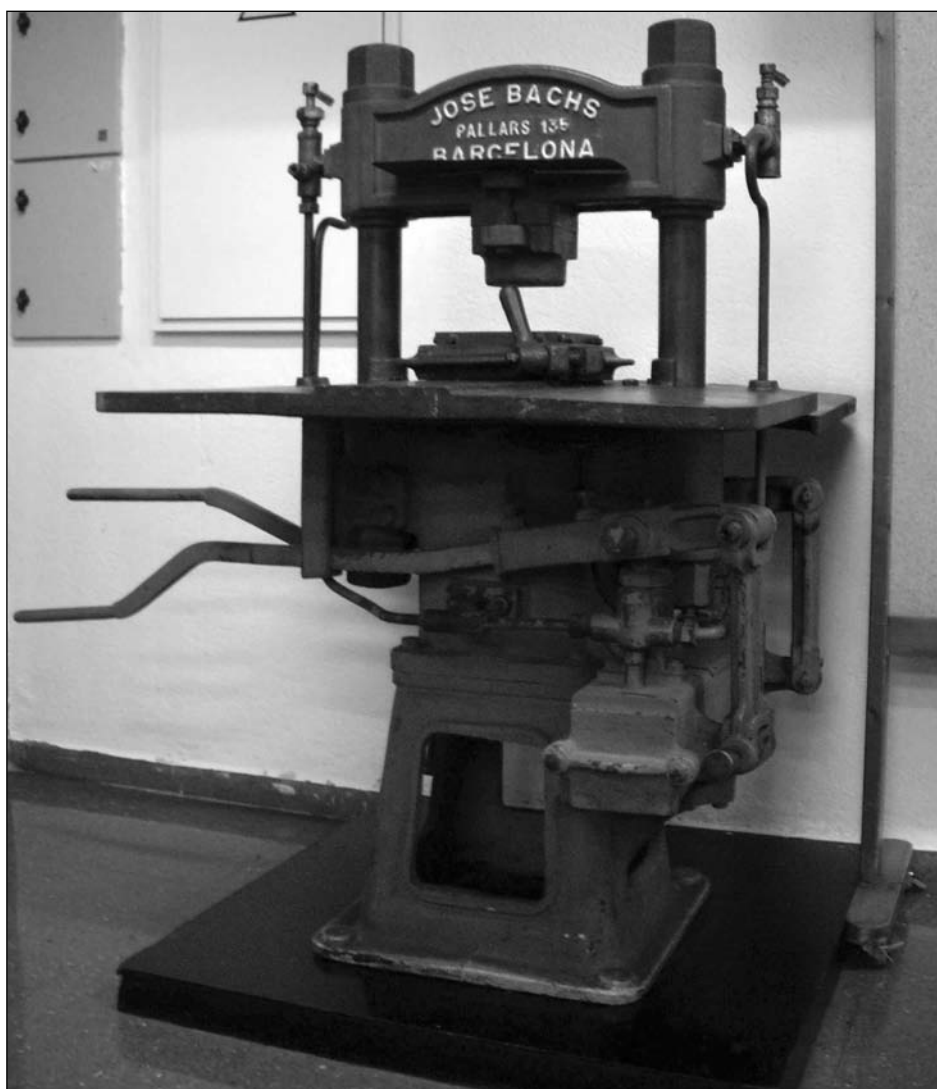
Prensa hidráulica (Fotografía de Jordi Grisè)
