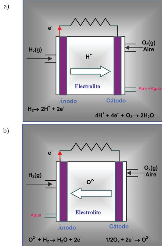
Figura 1 Esquemas de celdas de combustible con electrolito: a) conductor por H<sup>+</sup> y b) conductor por O<sup>2-</sup>.
