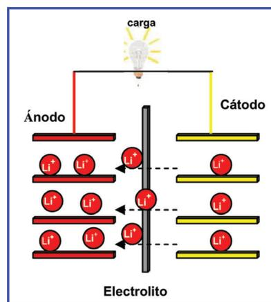
Figura 5. Esquema de una batería de ion litio.
