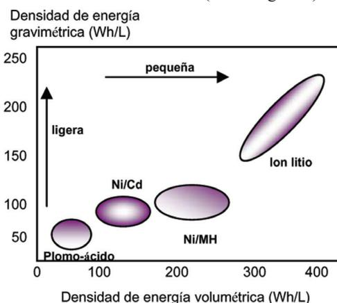
Figura 2. Comparación entre las densidades de energía gravimétrica y volumétrica en diferentes baterías recargables.
