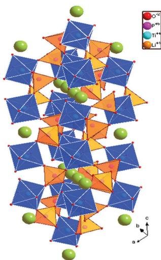
Figura 6. Perspectiva de la estructura tipo NASICON en la que se visualizan los túneles, a través de los cuales tiene lugar la conducción rápida.
