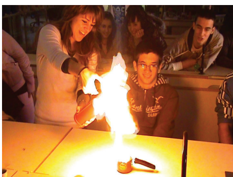
Figura 3. Expansión de las llamas al añadir agua a un fuego de heptano que simula al típico de aceite inflamado en una sartén.
