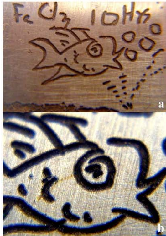
Figura 1: Placa de cobre grabada con cloruro de hierro y ácido acético, durante diez horas. Nótese la nitidez de las líneas excavadas en la superficie metálica, que aún con mayor detalle (Fig. b) se aprecia la homogeneidad de los surcos excavados.
