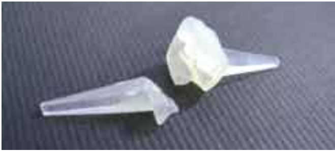
Figura 2. Prótesis MCP con rotura en la zona de unión entre el vástago proximal y el cuerpo intermedio.
