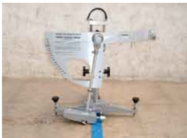
Figura 2. Equipo de ensayo según CTE. Péndulo de fricción.
