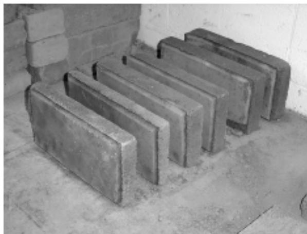
**Figura 9:** Baldosines de tosca prensada
