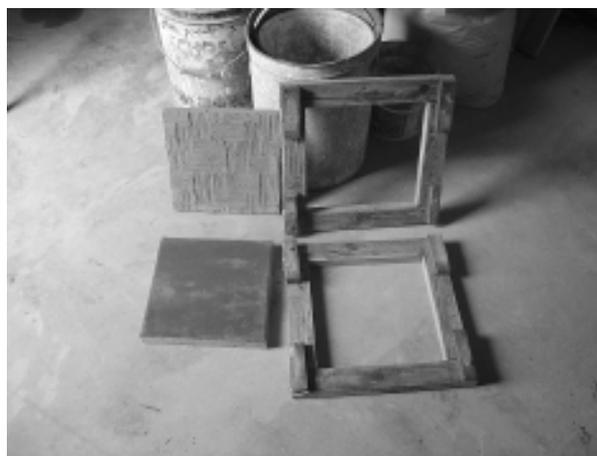
**Figura 10:** Baldosa bicapa de suelo estabilizado
